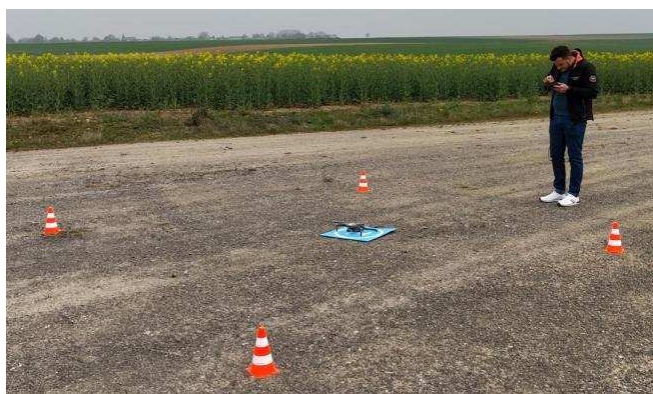
Photo 1 : Sécurisation de la zone de vol et contrôle des différentes autorisations nécessaires pour le bon déroulement du vol. Le vent doit être modéré pour permettre un bon déroulé : <10 mètres par seconde. A ce moment l'éolienne est à l'arrêt et le rotor est en Y inversé.
